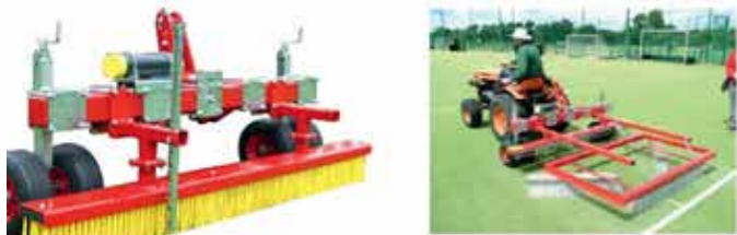
Opciók-baloldali fotó: a tartókeret és a boronások lecserezhetők kefére (balold-alon). Hátrula 3 kefesort tartalmazó keret is felszerelhető (jobbaldalon).
