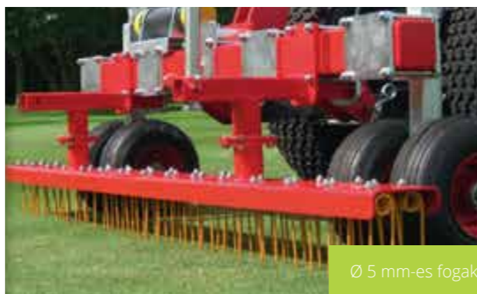
Opciók-baloldali fotó: a tartókeret és a boronások lecserezhetők kefére (balold-alon). Hátrula 3 kefesort tartalmazó keret is felszerelhető (jobbaldalon).
